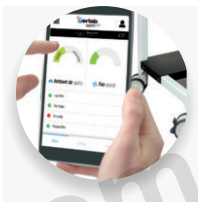
远程进入通风柜的工作状态界面，可实时设置及报警
